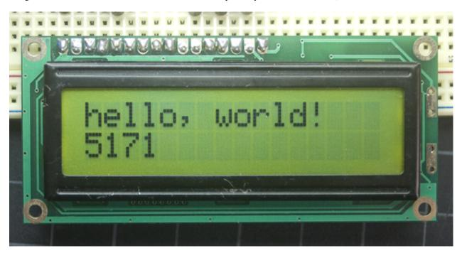
Fig. 1.1: Lcd display 1602
