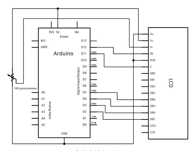
Fig. 3.4: Lcd display schem
